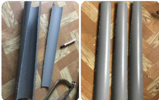
Rysunek 3: Wycinanie szablonu za pomocą piły (po lewej);
