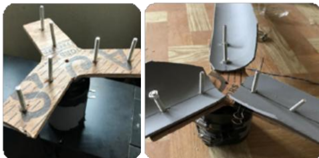
Rysunek 10: Mocowanie łopat do generatora Na koniec pomaluj całość ochronną białą warstwą farby, a następnie umieść całą turbinę wiatrową na wieży z mocowaniem łożyskowym, aby mogła się swobodnie obracać, orientując się zgodnie z kierunkiem wiatru
