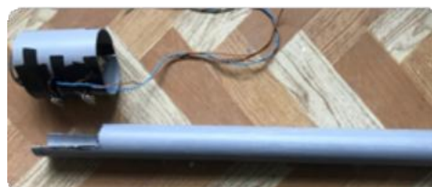
Rysunek 5: Kształt litery L wycięty z belki ogonowej na generator; Szczelina na belce ogonowej na płetwę ogonową
