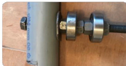
Rysunek 6: Mocowanie wału odchyłania do wysięgnika ogonowego
